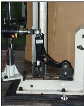
**Figura1:** *Prova del braccio oscillante Thyssen.*
