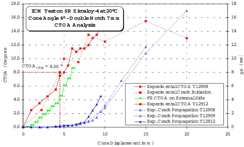
Figure 6 : CTOA & Δa versus cone displacement.
