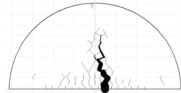
(d) Crack at final load step
