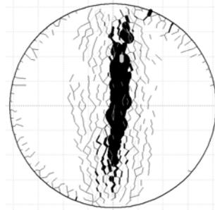
(d) Crack at final load step
