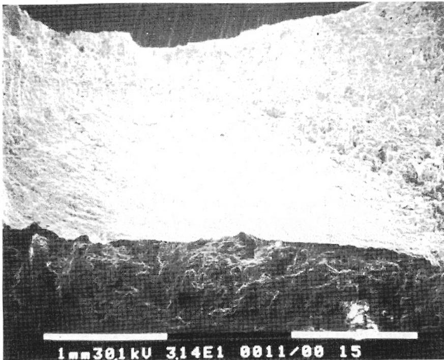
Fig. 6 - Prova di fretting-fatica: superficie di frattura.
