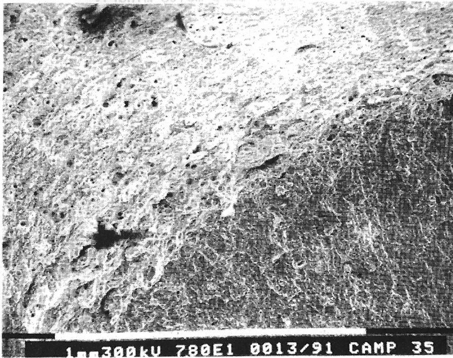
Fig. 9 - Pori nella zona di rottura statica e di fatica.
