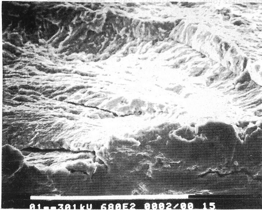
Fig. 7 - Avanzamento della rottura su più piani paralleli.
