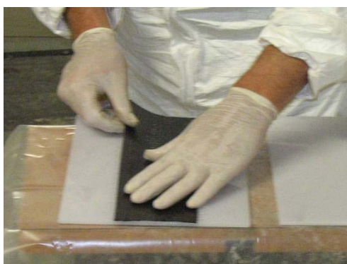
Figura 2: Cokit test: fase di incollaggio del tessuto CFRP su supporto in teflon.
