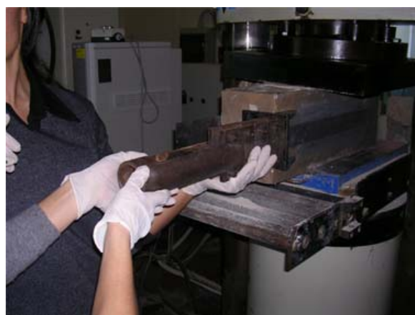
Figura 8: Unità 5 - Prova in laboratorio con attrezzatura proposta per le prove in situ.
