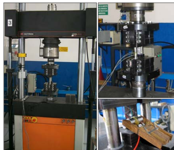
Figura 2: apparato sperimentale per le prove di trazione con particolare di montaggio dei trasduttori per le emissioni acustiche
