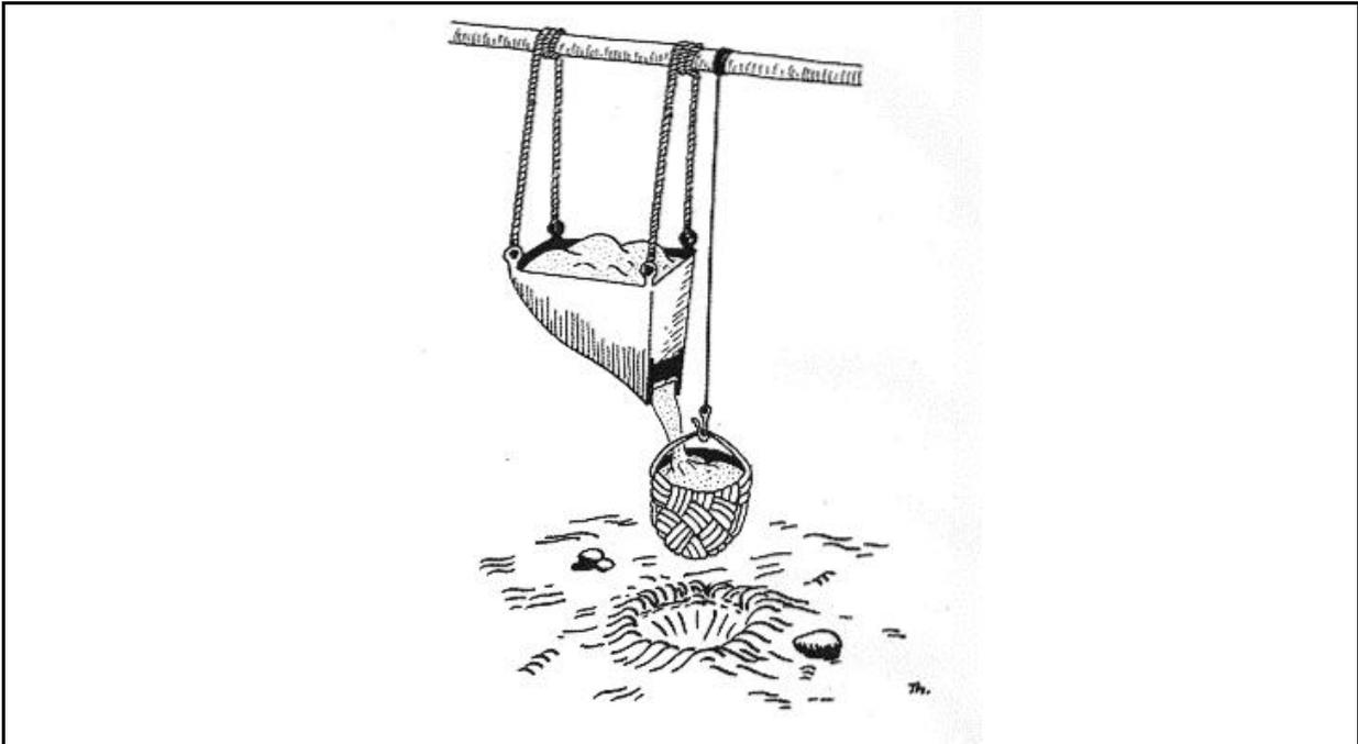
Figure N° 1 : Schéma de l'expérience menée par Léonard de Vinci (15/04/1452-2/05/519), sur la résistance de fils de fer.
