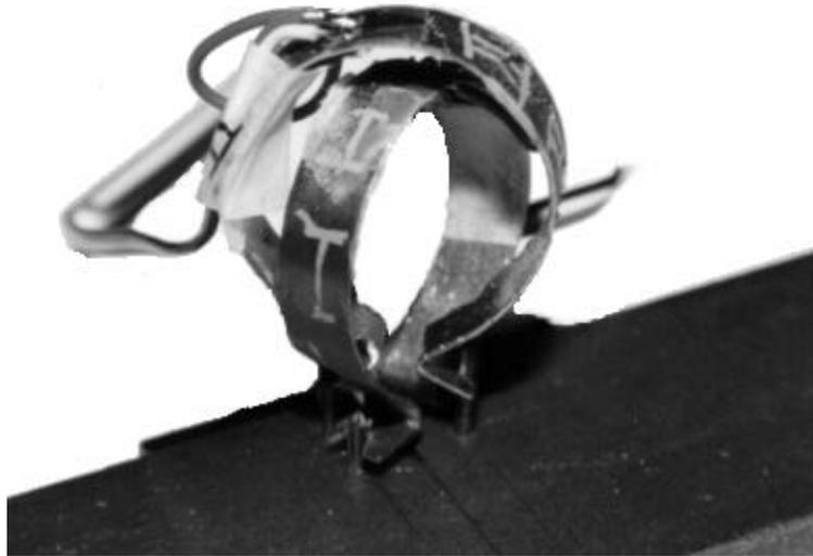
Fig. 4: estensometri per la misura degli spostamenti  $u_1$  e  $u_2$ .
