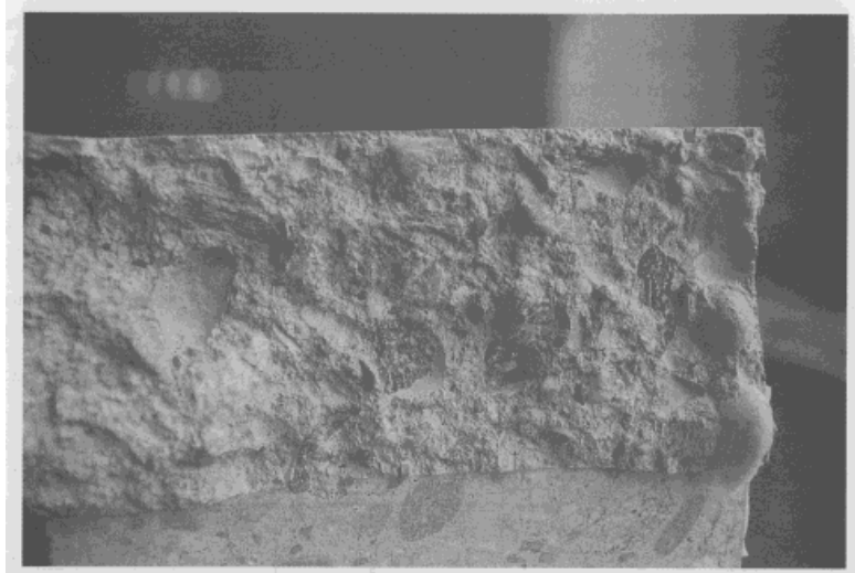
Figura. 10: Superficie di frattura. Si possono notare intere zone di "scollature" di inerti anche grandi e notevoli "asperità", indice di deviazioni del piano medio teorico di frattura: è evidente la superficie frattale.
