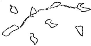
CRACKS DI COLLEGAM. DEI PORI
