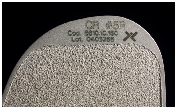
Figura 2: Finitura superficiale interna in titanio poroso della componente femorale. Figure 2: Porous titanium surface roughness of the femoral component.
