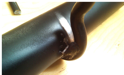
Figura 11: Cricca prodotta dalle prove dinamiche.
