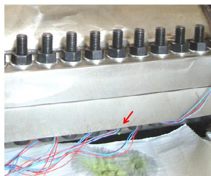
Figura 10: Prove in scala ridotta con liquido in pressione (acqua colorata). Evidenza di perdita
