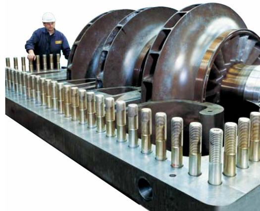
Figura 1: Tipiche dimensioni di un compressore centrifugo e relativa flangia bullonata di tenuta.
