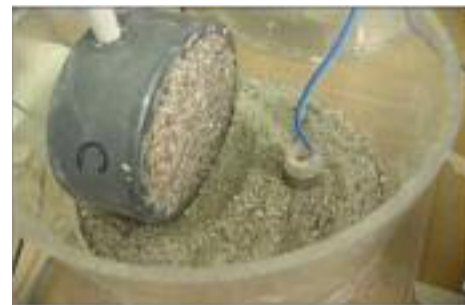
FIG. 7 Cella di prova: sonda e anodo di magnesio.
