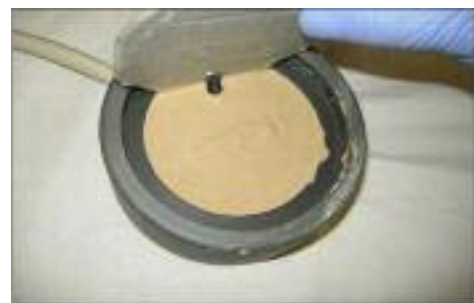
FIG. 5 Preparazione della sonda: colata del backfill.
