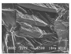
(d)  $300^{\circ}$ C,  $da/dN = 3 \ 10^{-6}$  mm/cycle,  $\Delta K = 7.0 \text{ MPa}\sqrt{\text{m}}$
