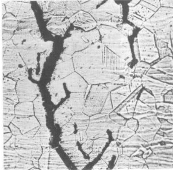
Fig. 9 - Frattura trangranulare (500x)
