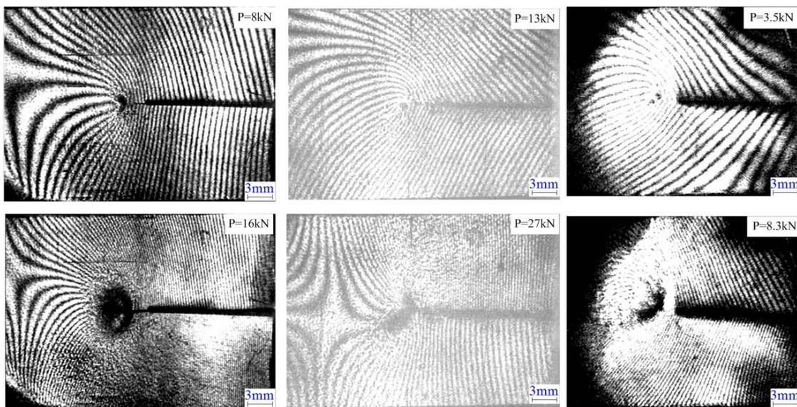
(a)  $b=4\text{mm}$ ,  $500^\circ\text{C}$ ,  $\beta=0^\circ$       (b)  $b=7\text{mm}$ ,  $500^\circ\text{C}$ ,  $\beta=27^\circ$       (c)  $b=2\text{mm}$ ,  $500^\circ\text{C}$ ,  $\beta=53^\circ$
